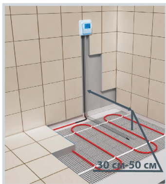
Схема укладки датчика температуры в гофрированной трубке
